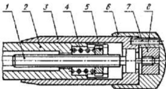
Головка волномера: 1 — проводник внутренний, 2— корпус резонатора, 3— барабан, 4 — пружина, 5 — гайка M5×0,5.8 по ГОСТ 11871—80, 6— головка, 7 — винт M2,5×12.58 по ГОСТ 1477—75, 8 — крышка.
