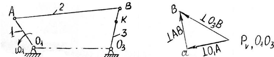
5. Начертите схему рычажного механизма. Дайте его звеньям техническое название, а также понятие о звеньях входных, выходных и неподвижных.
