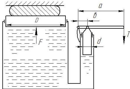
77. Определить величину и направление силы  $F$ , приложенной к штоку поршня для удержания его на месте. Справа от поршня находится воздух, слева от поршня и в резервуаре, куда опущен открытый конец трубы, - жидкость (масло трансформаторное,  $\gamma = 9810 \text{ Н/м}^3$ ). Показание пружинного манометра  $P_m = 0,08 \text{ МПа}$ ;  $H=5 \text{ м}$ ;  $D=100 \text{ мм}$ ;  $d=50 \text{ мм}$ .
