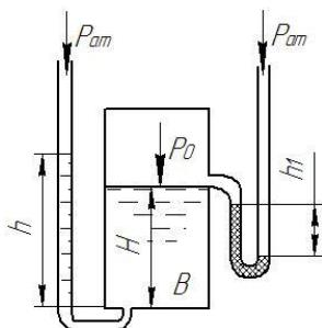
71. Определить абсолютное гидростатическое давление в точке  $A$  закрытого резервуара с водой, если высота столба ртути в трубке дифманометра  $h=0,25$  м, а линия раздела между ртутью и водой расположена ниже точки  $B$  на величину  $h_1=1$  м, точка  $B$  выше точки  $A$  на величину  $h_2=0,35$  м. Атмосферное давление  $P_{am}=98,1$  кПа, плотность воды  $\rho_w=1000\text{ кг}/\text{м}^3$ , плотность ртути  $\rho_{pt}=13340\text{ кг}/\text{м}^3$ .
