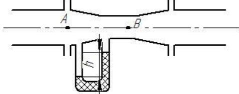
74. Определить разность показаний ртутного дифманометра  $h_x$ , составив уравнение равновесия относительно плоскости равного давления. Дифманометр подключен к двум закрытым резервуарам с водой, давление в резервуаре  $A$  равно  $P_a=190$  кПа, а в резервуаре  $B$   $P_b=160$  кПа.
