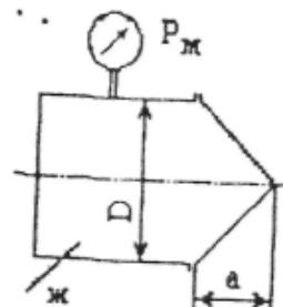
87. По трубопроводу диаметром  $d= 12$  мм и длиной  $l= 685$  м движется жидкость  $\text{Ж}$  (вода). Чему равен напор  $H$ , при котором происходит смена ламинарного режима турбулентным? Местные потери не учитывать. Температура жидкости  $t=20$  °C.
