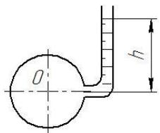
69. Найдите давление на свободной поверхности в закрытом сосуде с жидкостью, если уровень ее в открытом пьезометре выше уровня жидкости в сосуде на  $h=0,45$  м. Относительная плотность жидкости  $\delta=0,85$ .
