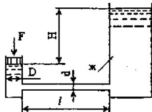
85. Определить силу прессования  $F$ , развиваемую гидравлическим прессом, у которого диаметр большого плунжера  $D= 300$  мм, диаметр меньшего плунжера  $d= 75$  мм. Большой плунжер расположен выше меньшего на величину  $H= 1$  м, рабочая жидкость  $\text{Ж}$  (вода), усилие, приложенное к рукоятке  $R=50$  Н.
