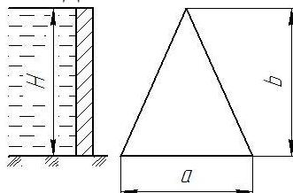
90. Требуется определить силу избыточного давления воды на плоскую прямоугольную стенку, наклоненную к горизонту под углом  $\alpha=60^\circ$ . Глубина воды  $H=1,0$  м, ширина стенки  $B=2,0$  м. Найти точку приложения этой силы.
