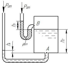
73. Определить разность давлений в точках  $A$  и  $B$  расходомера Вентури, если показание ртутноводяного дифференциального манометра  $h=5,0$  см.
