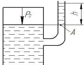
70. Закрытый резервуар  $B$ , заполненный водой, снабжен ртутным вакуумметром и пьезометром.
