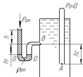
72. Определить высоту подъема воды в пьезометре  $h_x$ , если высота столба ртути в трубке дифманометра  $h_1=0,2$  м, а точка  $A$  расположена на глубине  $h_2=4$  м от свободной поверхности. Атмосферное давление  $P_{am}=98,1$  кПа, плотность воды  $\rho_w=1000\text{ кг}/\text{м}^3$ , плотность ртути  $\rho_{pt}=13340\text{ кг}/\text{м}^3$ .
