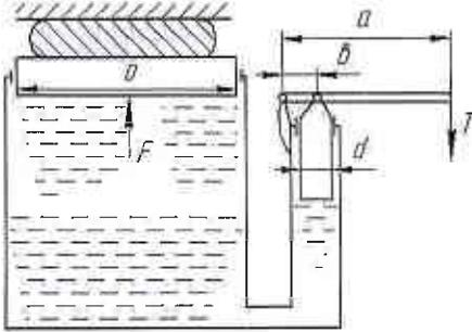
77. Определить величину и направление силы  $F$ , приложенной к штоку поршня для удержания его на месте. Справа от поршня находится воздух, слева от поршня и в резервуаре, куда опущен открытый конец трубы, - жидкость (масло трансформаторное,  $\gamma = 9810 \text{ Н/м}^3$ ). Показание пружинного манометра  $P_m = 0,08 \text{ МПа}$ ;  $H=5 \text{ м}$ ;  $D=100 \text{ мм}$ ;  $d=50 \text{ мм}$ .
