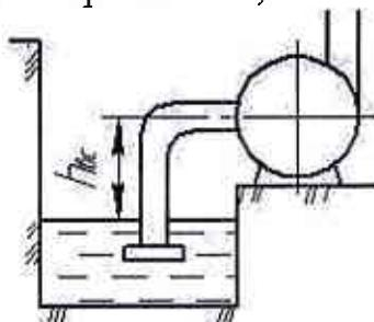
96. Центробежный насос с заданной при  $n=1600$  об/мин характеристикой перекачивает воду из резервуара с отметкой  $\Delta 5$  м в резервуар с отметкой  $\Delta$
