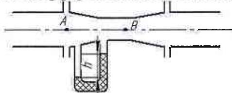
74. Определить разность показаний ртутного дифманометра  $h_x$ , составив уравнение равновесия относительно плоскости равного давления. Дифманометр подключен к двум закрытым резервуарам с водой, давление в резервуаре  $A$  равно  $P_a=190$  кПа, а в резервуаре  $B$   $P_e=160$  кПа.
