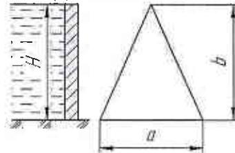
90. Требуется определить силу избыточного давления воды на плоскую прямоугольную стенку, наклоненную к горизонту под углом  $\alpha=60^\circ$ . Глубина воды  $H=1,0$  м, ширина стенки  $B=2,0$  м. Найти точку приложения этой силы.
