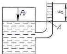
70. Закрытый резервуар  $B$ , заполненный водой, снабжен ртутным вакуумметром и пьезометром.
