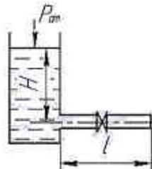
93. По трубе диаметром  $d=100$  мм протекает вода с температурой  $t=30^\circ\text{C}$ . Абсолютная шероховатость трубы  $\Delta=0,25$  мм. Расход воды  $Q=0,05$  л/с. Установить режим движения жидкости и определить значение коэффициента трения  $\lambda$ .
