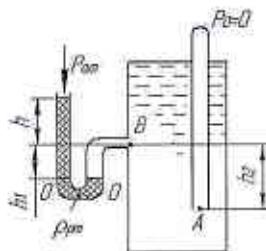
72. Определить высоту подъема воды в пьезометре  $h_x$ , если высота столба ртути в трубке дифманометра  $h_1=0,2$  м, а точка  $A$  расположена на глубине
